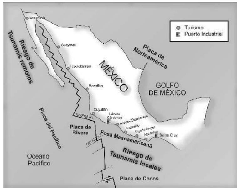
Figura 34. Escenario sismo-tectónico de la costa del Pacífico de México y su potencial para generación y recepción de Tsunamis. Fuente: CENAPRED.
